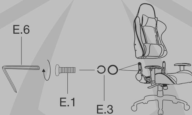
7. Одягніть захисні кришки на кронштейни шарнірів і закріпіть їх гвинтами за допомогою хрестоподібної викрутки.
