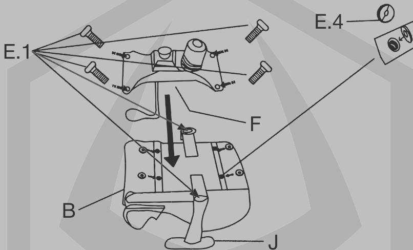
5. Помістіть блок сидіння на блок основи крісла, вставивши циліндр пневматичного підйомного механізму в центральний отвір в основі сидіння з механізмом регулювання.
